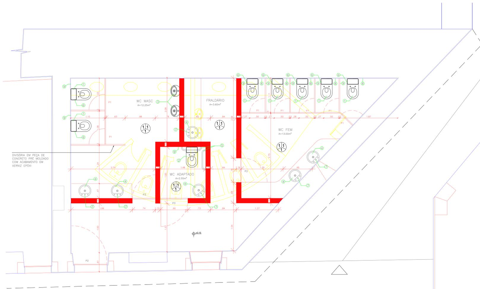
DIVISÓRIA EM PEÇA DE CONCRETO PRÉ-MOLDADO COM ACABAMENTO EM VERNIZ EPOXI
