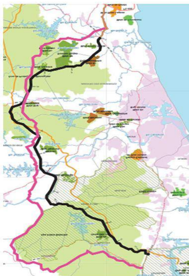
Figura 11: Traçado do Arco Metropolitano. Na cor preta, o traçado original e na cor rosa, o novo traçado.
