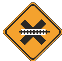
A - 39 PASSAGEM DE NÍVEL SEM BARREIRA
