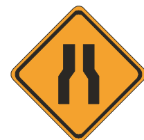
A - 21b ESTREITAMENTO DE PISTA AO CENTRO
