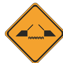
A - 23 PONTE MÓVEL
