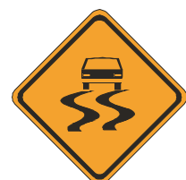
A - 28 PISTA ESCORREGADIA
