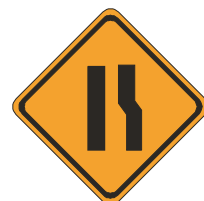
A - 21c ESTREITAMENTO DE PISTA À DIREITA
